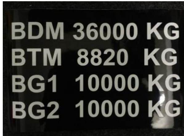
Rajah 7. Contoh plat berat muatan kayu balak yang ditampal di lori treler.
